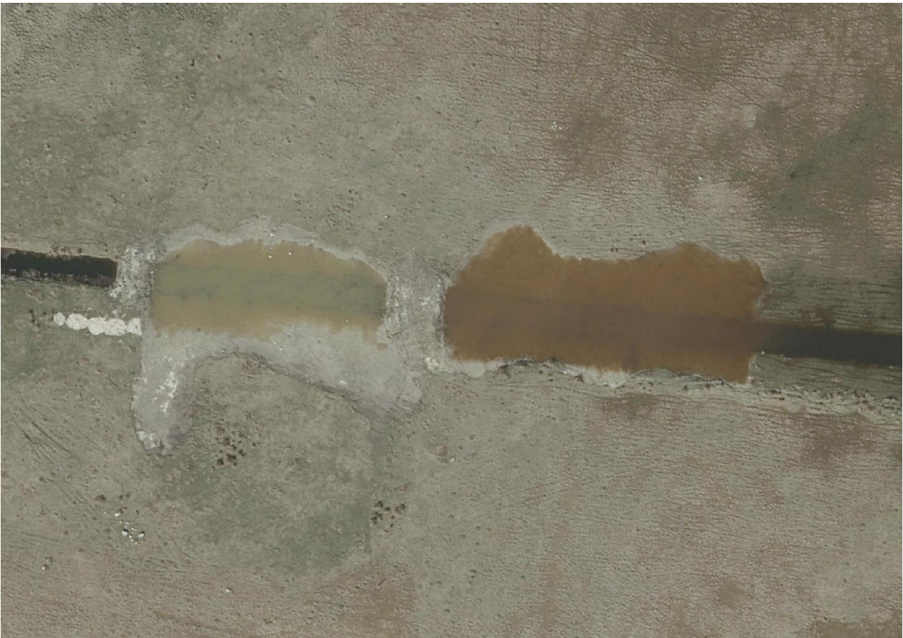
Eksempel på omdannelse af smalle, stejle grøfter til lavvandede oversvømmelser.
